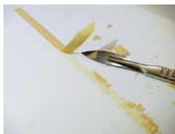
テープ除去作業
