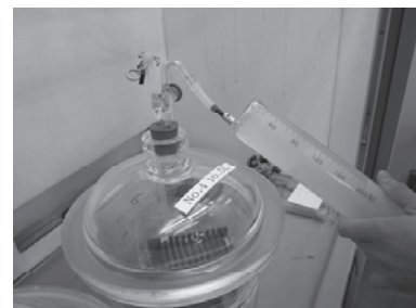
写真2 10Lデシケーターに試料を入れ、投薬 7)
