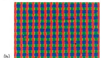
写真3: 試料としたDufaycolorの画像(a)、Dufaycolorのカラー・スクリーン(b)
